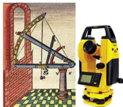
Рис. 4. Секстант Тихо Браге и современный теодолит
